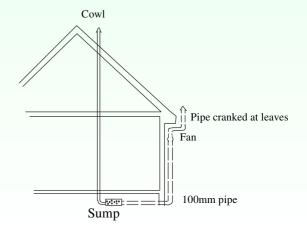
TYPICAL LAYOUT OF RADON SUMP
